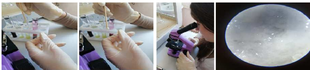
Рис. 5. Размещение «нитей» на предметное стекло (два фото слева), изучение волокон под цифровым микроскопом (два фото справа)
